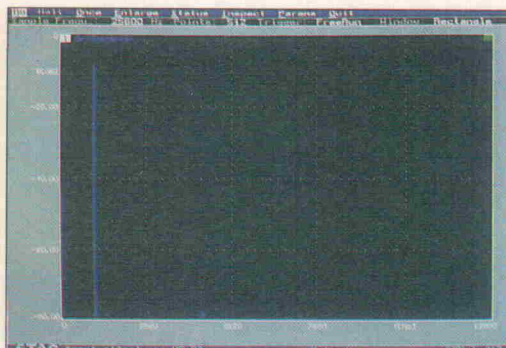
Bild 7. 99-kHz-Signal mit Blackman-Harris-Fensterung.
